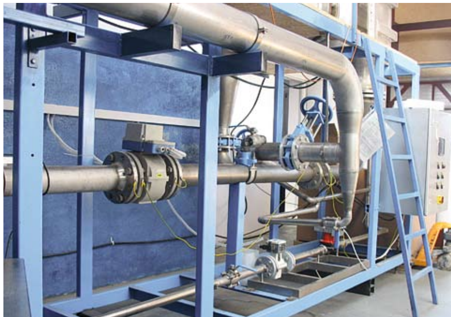
W laboratorium ALFINE-TIM najczęściej miejsca zajmuje układ do badania i kalibracji przepływomierzy.
