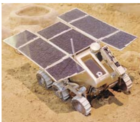
Model robota-łazika, który będzie odpowiedzialny za zebranie próbek z powierzchni Marsa i analizę ich mineralogii. (Fot. Jastrow/Wikimedia Commons)
