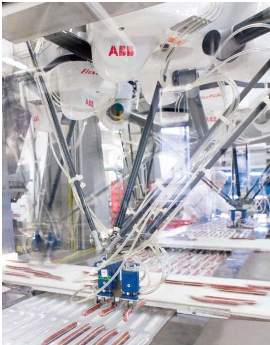
FlexPicker pakujący kielbaski salami w niemieckiej fabryce Unilever. (Fot. Arch. ABB)
